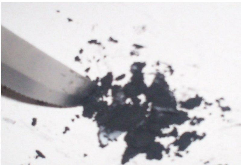
Figura 6- passo 5 :retirada do pó preto de dióxido de manganês
