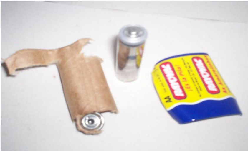
Figura 3-passo 2: retirada da camada de papelão
