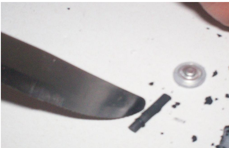
Figura 5-passo 4: retirada do bastão de carbono
