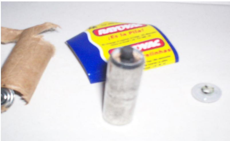
Figura 4-passo 3: retirada da parte superior
